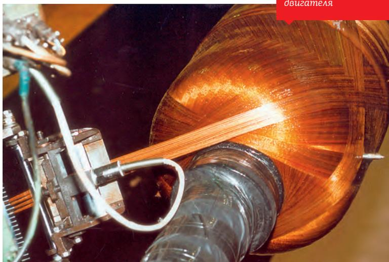
**Созданный корпус-«кокон» твердотопливного двигателя превзошел по параметру массовой эффективности самые совершенные на тот момент корпуса из высокопрочных сталей, подкрепленные композиционными материалами, и корпуса из композиционных материалов с металлическими днищами, соответственно, в 2,5 и 1,5 раза!**
