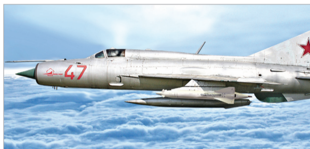
► Советский фронтовой истребитель МиГ-21ПФМ с авиационной управляемой ракетой X-66 разработки ОКБ «Звезда»
